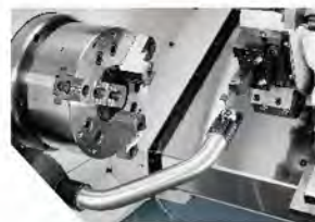
Manual/Auto Tool Presetter
